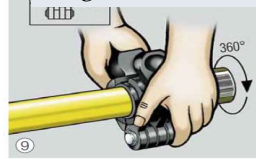
Abb. 83 Pressring aufklappen und auf den Pressverbinder setzen.
