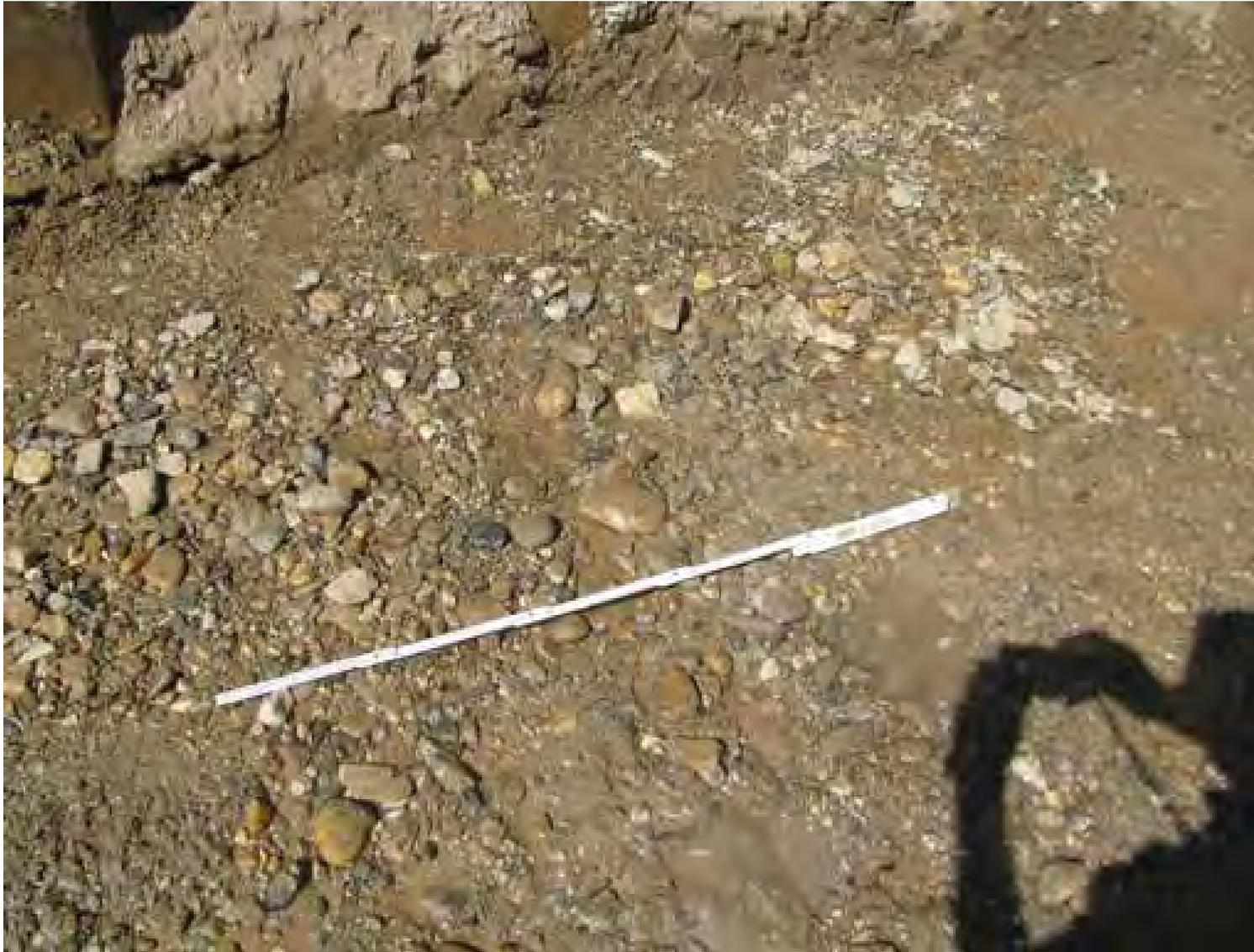
Erkundung mittels Rammkernsondierung ist äußerst problematisch!
