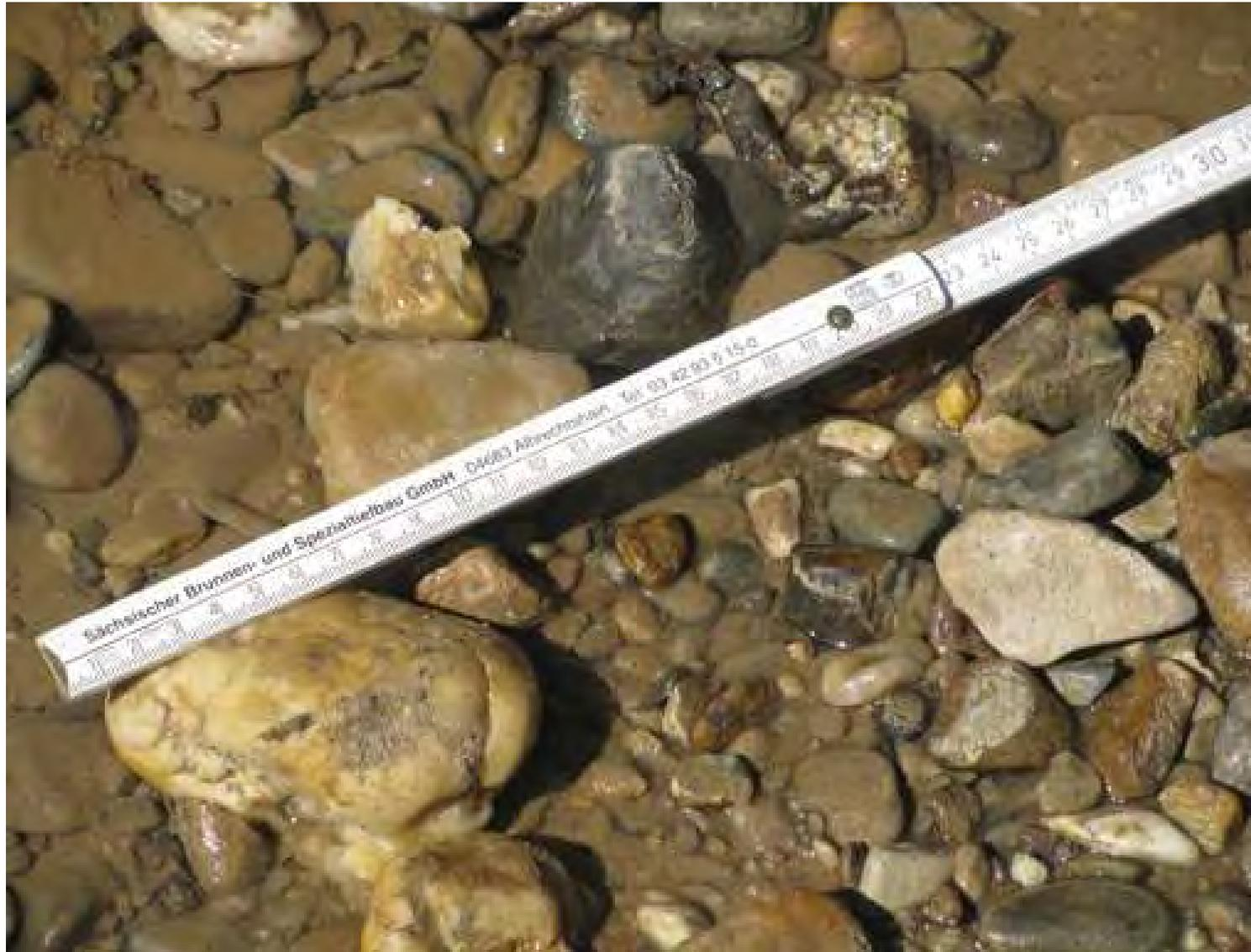
Diese Steine sind bereits für die Bohrung zu groß, um erfasst zu werden!
