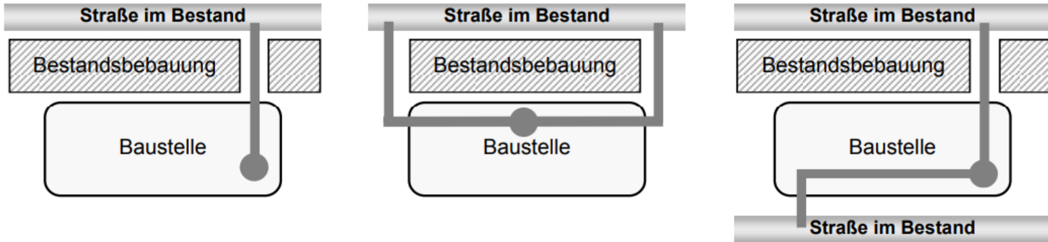
Abb. 5.13 Konzepte der Verkehrsanbindung von Baustellen, v.l.n.r.: Stichstraße zur Baustelle, Umfahrt = Durchfahrt durch die Baustelle parallel zu einer Bestandsstraße, Durchfahrt zwischen zwei Bestandsstraßen
