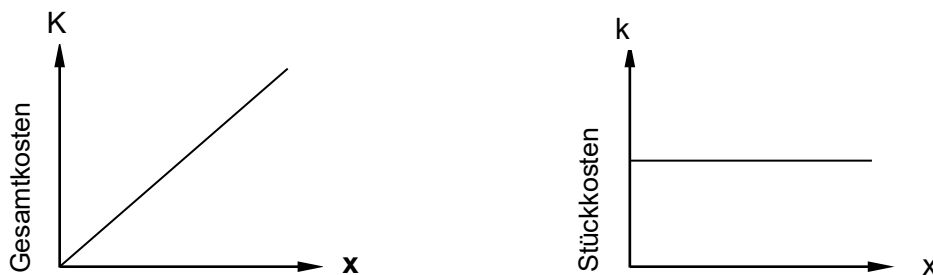
Bild 7 Zusammenhang zwischen Kosten und erzeugter Menge (bzw. Zeit) bei proportionalen Kosten (variable Kosten)
